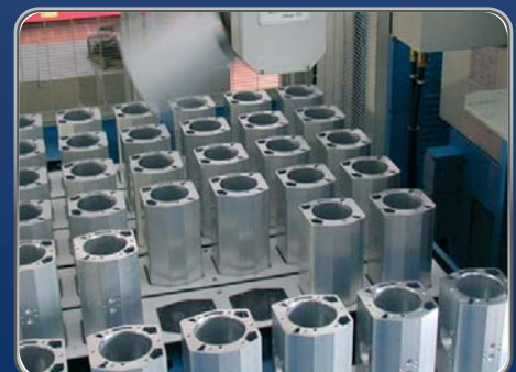
Ein Beladeroboter legt fertig bearbeitete Gehäuse auf einem Palettensystem ab. A handling robot places machined bodies onto a pallet.
