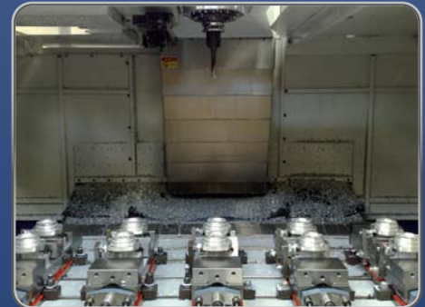
Bearbeiten von Antriebsteilen für □-Stoffschieber. Machinery of actuator parts for □-knife gate valve.
