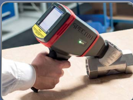
Werkstoffanalyse mit Hilfe eines energiedispersiven Röntgenfluoreszenzgeräts. Material testing with a energy dispersive X-ray fluorescence device.
