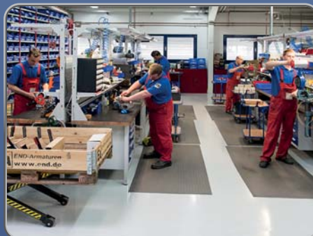
Montage der EA -Antriebe auf Kugelhähne oder Absperrklappen. Assembly of the EA -actuators with ball valves or butterfly valves.
