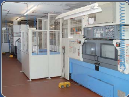
Vollautomatische 8-Achsen CNC-Maschinen. Fully automatic 8-axe CNC-Machines.
