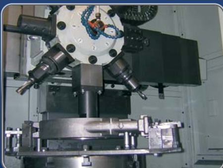
Bearbeiten von bis zu 180kg schweren und 1.000mm großen Gehäusen für □-Stoffschieber. Machinery of bodies for □-knife gate valves up to 180kg and 1.000mm length.
