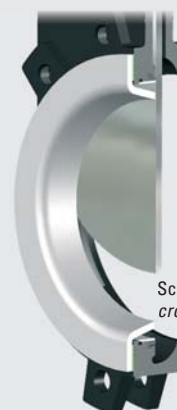
Kegelblende für abrasive Medien, um das Medium in den Mittelstrom zu lenken. / Abrasive media deflector directs media into main stream
